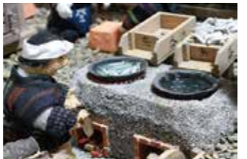
海水を沸騰させた大釜で鯨を煮て、角胴で压榨して鯨粕を作る。
